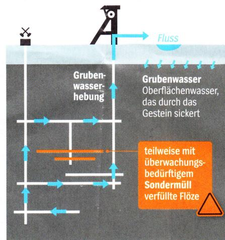
Wird die Wasserhebung eingeschränkt, steigt das Grubenwasser an. Schadstoffe könnten aus dem Müll gelöst werden und ins Grundwasser gelangen.
